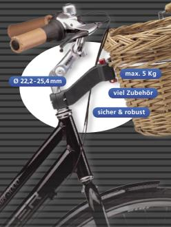
Lenkeradapter aus glasfaserverstärktem Polyamid zur Montage am Vorbau. Günstige Zubehörposition mit niedrigem Schwerpunkt. Mehr Freiraum am Lenker für Tacho, Klingel etc. Bei neigungsverstellbaren Vorbauten bleibt die Position von Korb oder Tasche unabhängig von der Einstellung des Vorbauwinkels.
